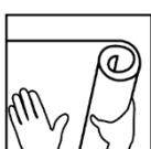
При наклеивании стеклохолста на гипсокартон, рекомендуется наклейка встык, **без подрезки**, с последующим шпаклеванием.
