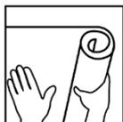
3. Для улучшения адгезии, а также снижения последующего расхода краски и шпаклевки, рекомендуется нанести поверх стеклохолста слой клея. Излишки убираются шпателем.
