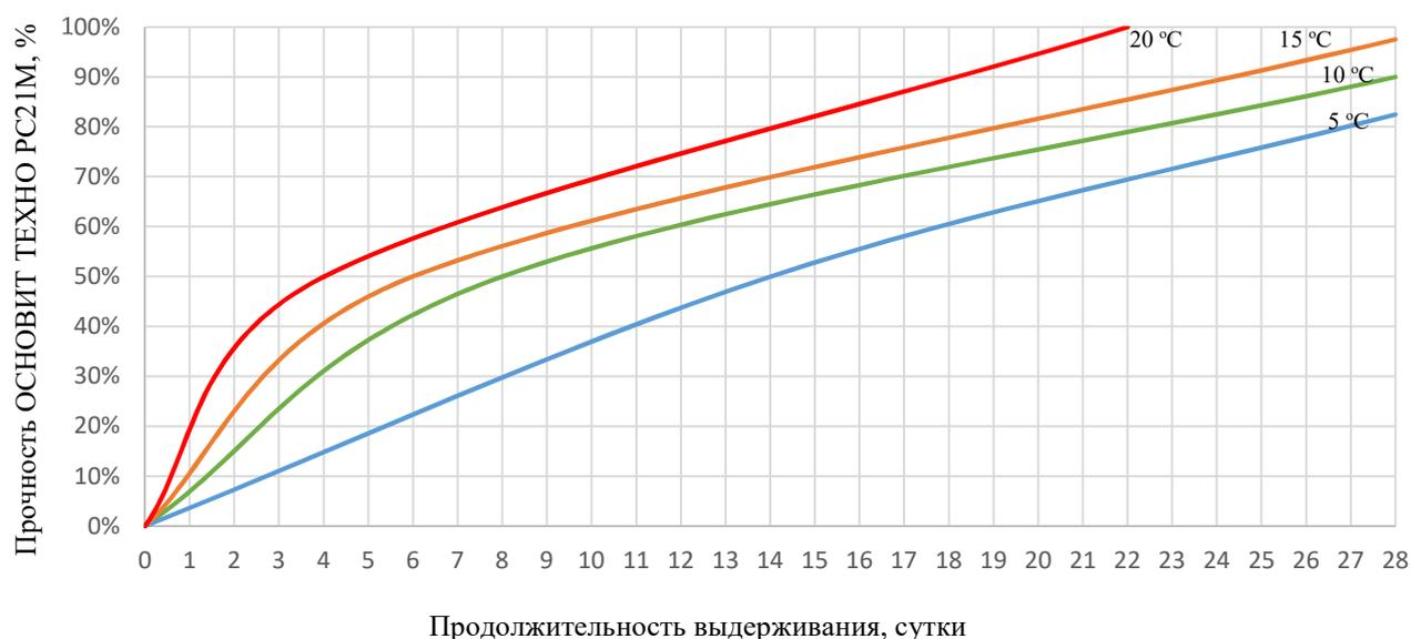
Рис.1. Прочность цементной штукатурки *ОСНОВИТ ТЕХНО РС21М* в зависимости от температуры и продолжительности выдерживания.
